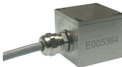
Model 4332M3は、4-20mA出力のDC応答3軸一体型MEMS加速度計です。加速度計筐体は耐腐食・耐圧ステンレススチールハウジングで保護されており、専用の防水ケーブルにより最大40mまでの防塵防滴IP68(完全防水)保護を実現しています。計測レンジは±2g～±20gから選択可能です。0℃～+65℃の範囲で温度補正がされており、動作温度範囲は-40℃～+85℃です。
